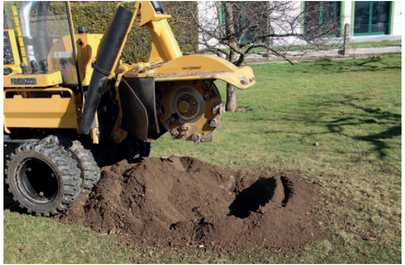
Nach Ende der Fräsung bleibt eine Mischung aus Holzspänen und Erde
