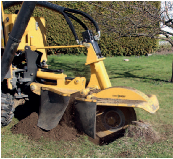
Die Fräse kann zur Zerspaltung des Strunkes waagrecht und senkrecht geschwenkt werden
