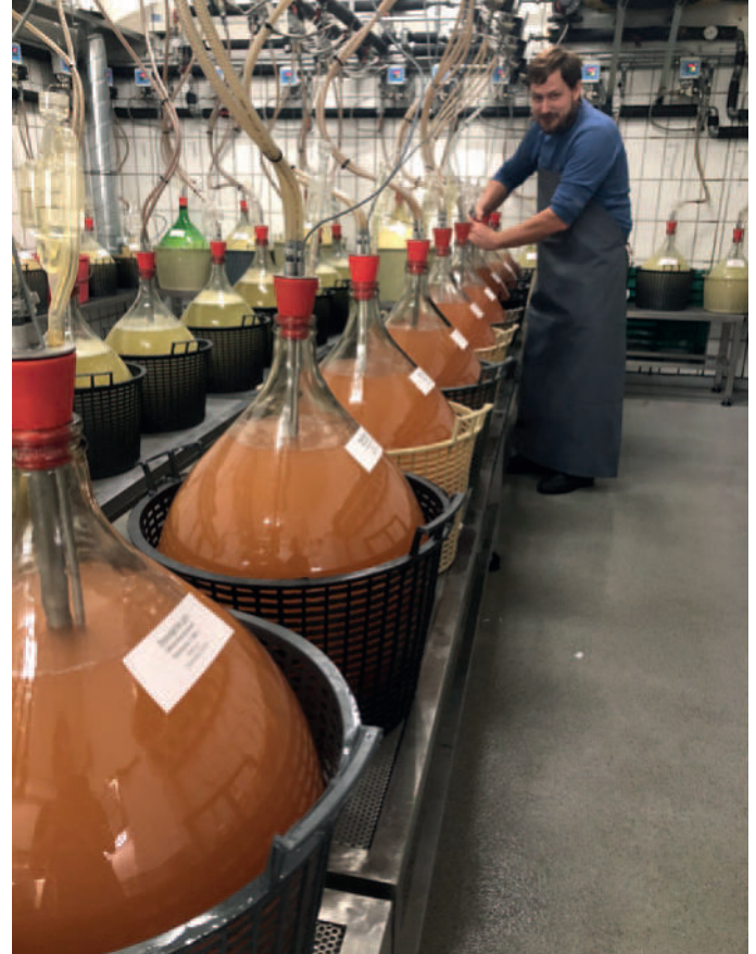
Martin Nowak in der Mikrovinifikation beim Hefeansatz und Installation der Kühlung. Durch eine tägliche Dichtebestimmung mit einem Handbiegeschwinger der Firma Anton Paar wurde der Gärverlauf dokumentiert.
