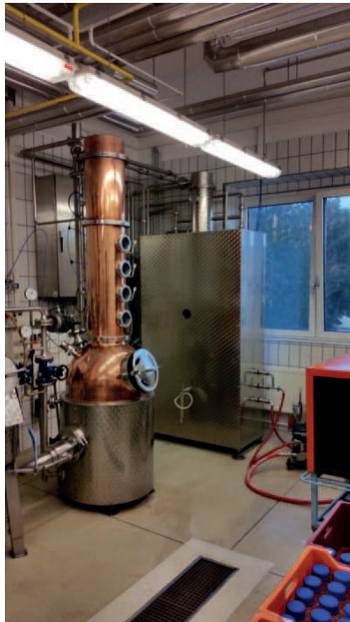
Abbildung 2: Vakuumdestillationsanlage CARL, 120 Liter
